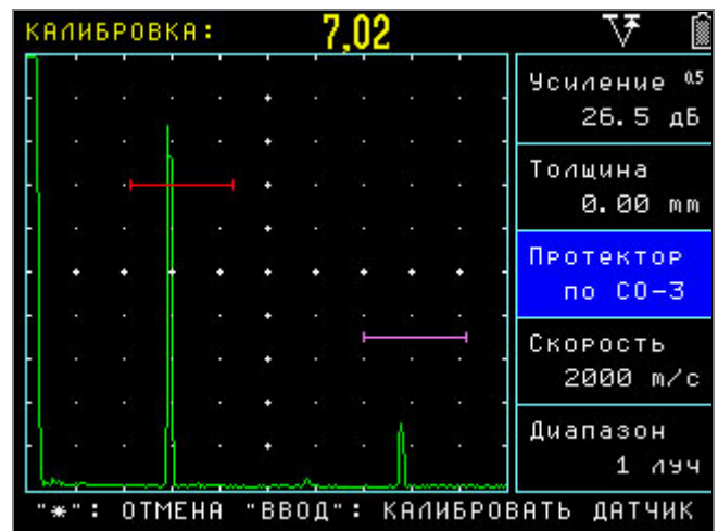
рис.3-4 Калибровка наклонного преобразователя по образцу СО-3
