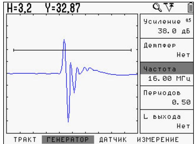
а) Широкополосный преобразователь 15МГц, подключенный без демпфирования
