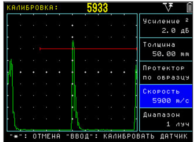
рис.3-7 Калибровка скорости распространения продольных УЗ колебаний в образце толщиной 50мм
