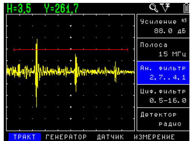
б) Сигналы после включения аналогового фильтра 2,7-4,1 МГц.
