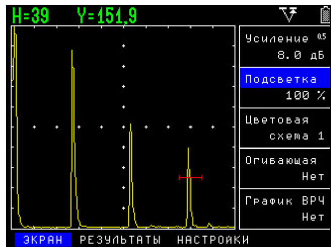
б) с центральной сеткой без заполнения
