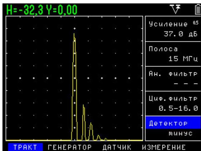
Рис.2-11 Отрицательное ½ волновое детектирование
